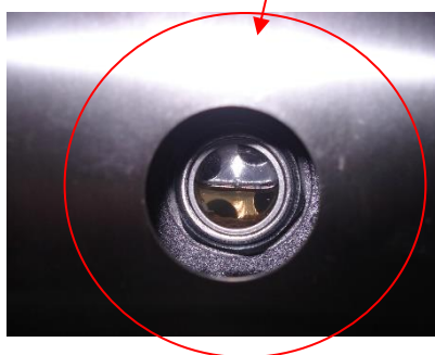
Illustration 1. Indicateur du niveau d'huile
