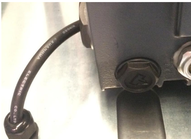
Illustration 5. Retirer le bouchon de vidange de l'huile
