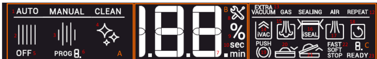
Figure 1. Écran LCD contenant tous les affichages éclairés
