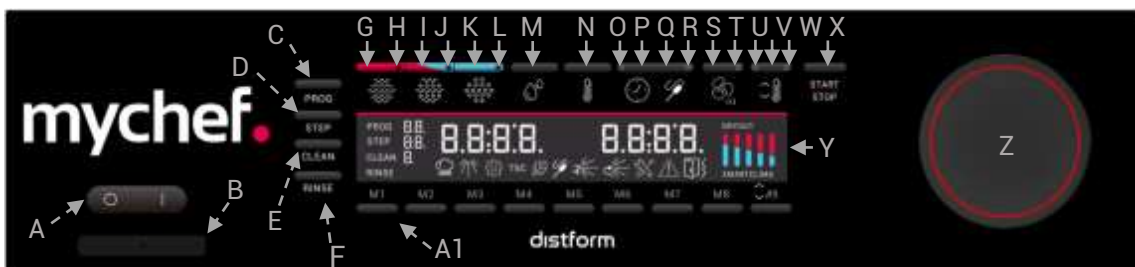
Figura 3: Descripción del panel de control.
